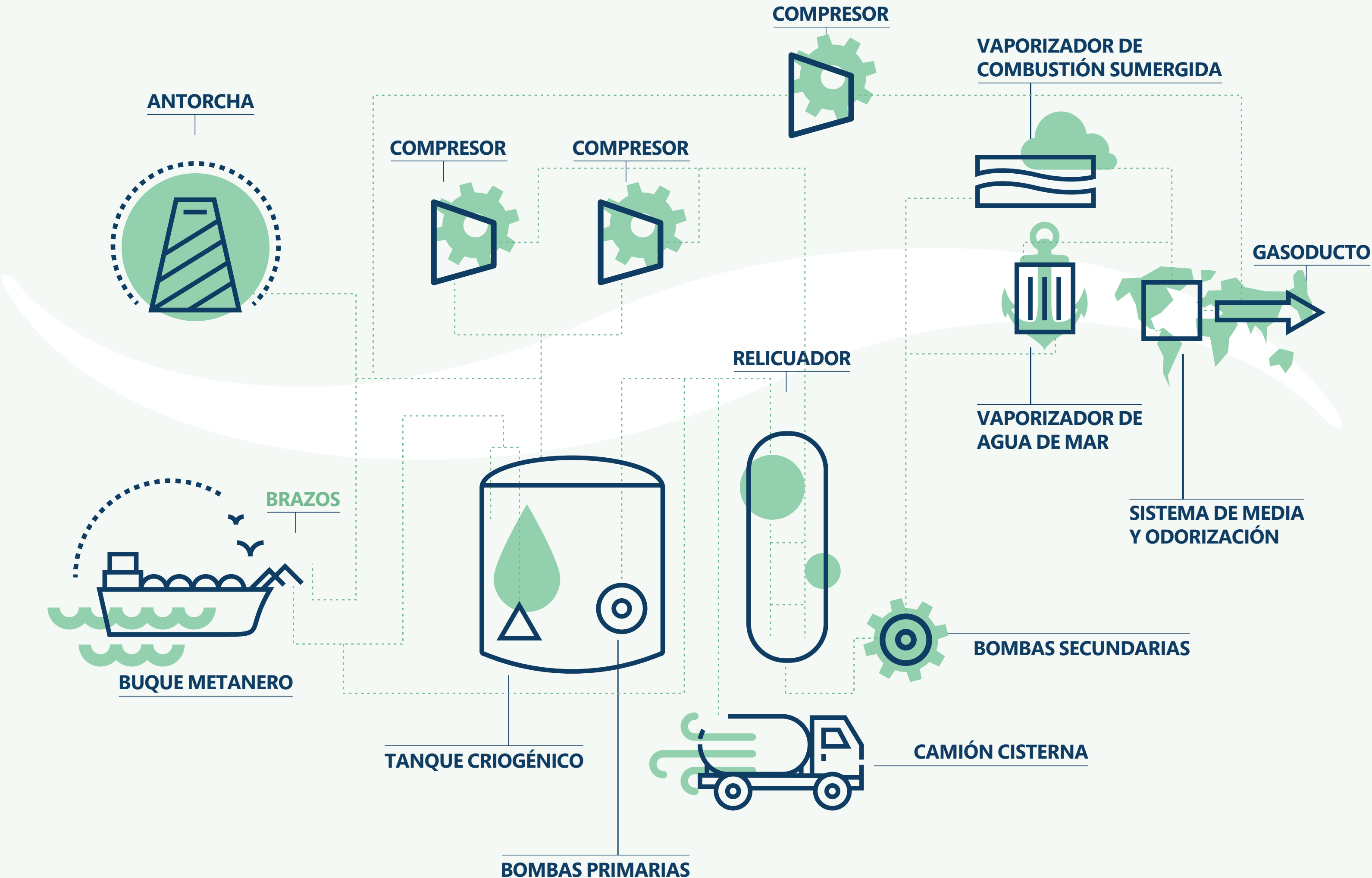
Figura 6. Características técnicas de la planta de Saggas. https://www.saggas.com/es/la-planta/procesos-de-la-planta/ .
